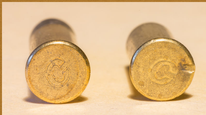
Zwei 5,6mm Kleinkaliber Patronen, die Rechte wurde wieder gezündet, was diesmal an der Einkerbung am Rand ersichtlich ist (daher auch der Name Randfeuerpatrone)
