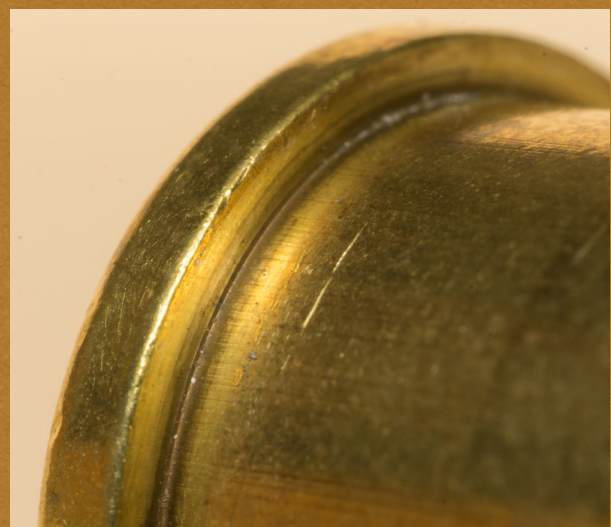
Auch die Patrone .303 Brit hat einen Rand, wobei das "R" in der englischen Kennzeichnung nicht vorkommt (die deutsche Bezeichnung wäre 7,7 × 56 mm R)
