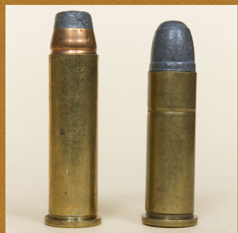
Kaliber .357 Magnum (links) im Vergleich zur im Durchmesser fast identischen Kaliber .38 Spezial Patrone
