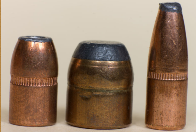
Drei Teilmantelgeschosse aus verkupferten Blei, ganz links mit Hohlspitzgeschoss, in der Mitte ein Flachkopfgeschoss und rechts ein Rundkopfgeschoss (wobei die Rundung bereits beschädigt ist)
