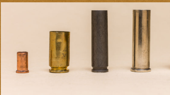
Hülsen aus verschiedenen Materialien, von links nach rechts: Kupfer, Messing, Stahl und Messing vernickelt
