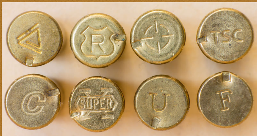
Acht Kleinkaliber-Patronen mit unterschiedlichen Herstellerzeichen, diese benötigen als Ausnahme keine weiteren Kennzeichnungen
