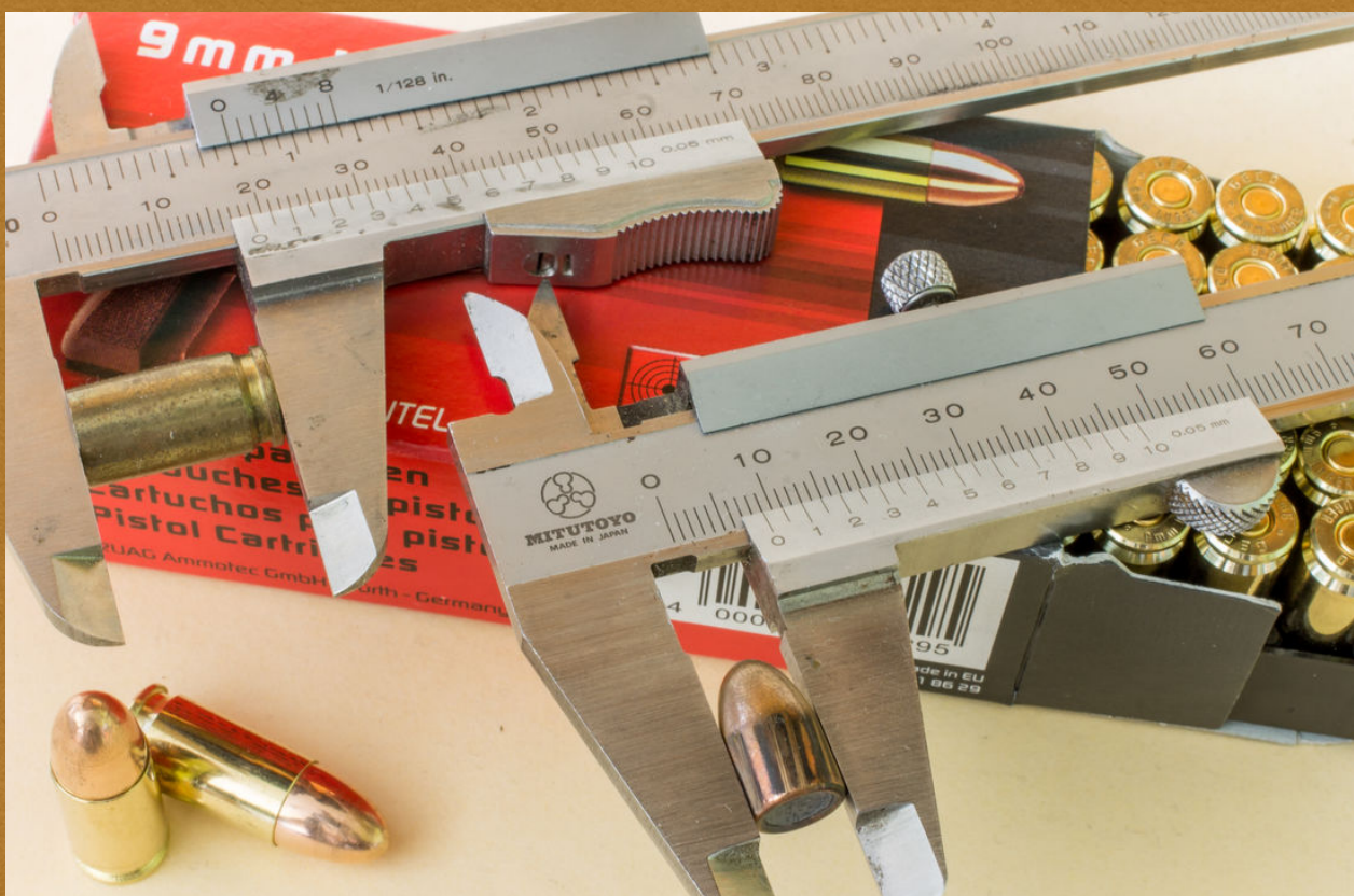
Veranschaulichung des zustande kommens der Kaliberbezeichnung 9x19mm Luger
