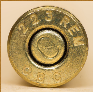
Das Kaliber .223 entspricht der deutschen Bezeichnung 5,56 × 45 mm
