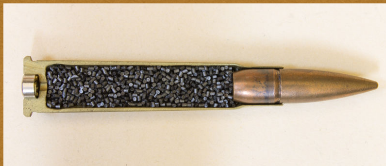
Querschnitt einer Patrone .303 Brit
